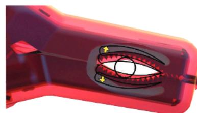
Megger-Klemme wird mit Prüffinger gemäß IEC-Norm auf Kriech und Abstand geprüft.
